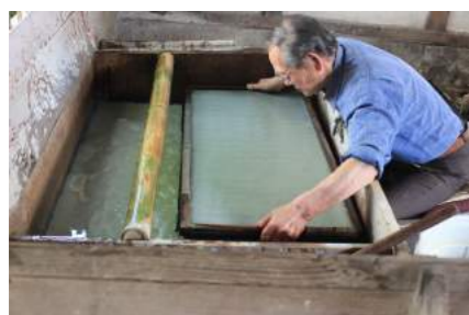
す 簀をあまり動かさない「溜め漉き」で製造。名塩和紙は泥を含み、更に漉き桁にひもを張らないので重いため、座った姿勢のままで漉くのも特徴です。
